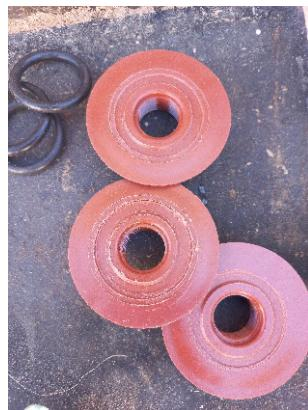
Se recomienda utilizar O´rings debido a que las gomas con las que suelen venir las bridas que se consiguen comercialmente no tienen la elasticidad necesaria para evitar pérdidas en este sistema. Sobre todo, esto sucede si la superficie del tanque interno no es totalmente regular y resistente a cambios de presión.
