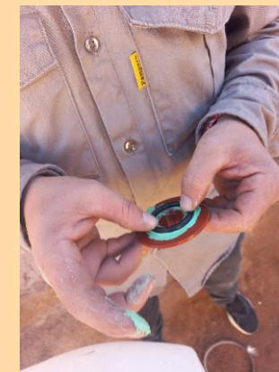
Al ajustar las roscas no se las debe forzar demasiado. Enroscar las bridas de manera tal de aplastar un poco los O'rings, pero no al punto de que éste se aplaste demasiado.
