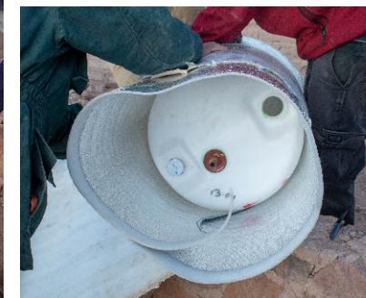
Cortar dos discos de telgopor del diámetro interior del tanque externo.
