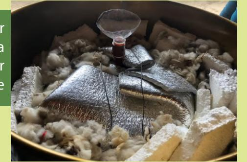
Procurar mantener el tanque siempre con agua, para evitar el sobrecalentamiento del colector y el funcionamiento de la bomba con aire en vez de agua.
