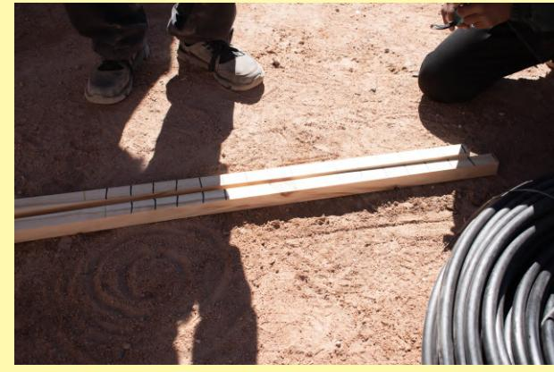
Calar triángulos en la madera que tengan como vértices cada una de las marcas realizadas, de manera tal que quede una especie de serrucho.
