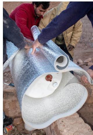
Envolver el tanque interno con una vuelta de membrana aislante aluminizada
