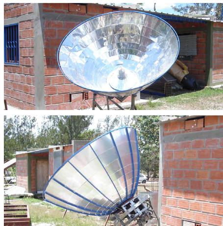
Aplicación del concentrador parabólico en motor Stirling, INENCO, Salta, 2010.
