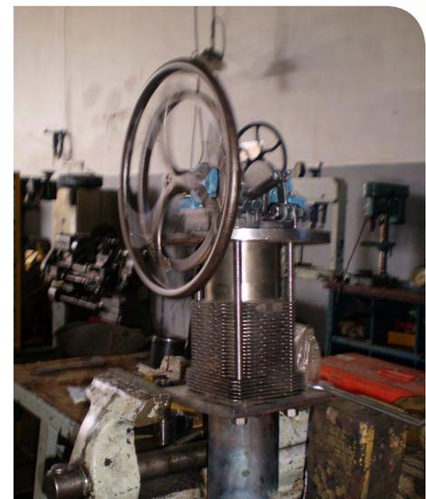
*Diseño y construcción de réplica de motor Stirling para generación de energía, 2007-2008.*
