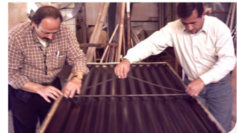
*Construcción de colectores solares de aire para calefacción en el taller del INENCO. Salta 2009.*
