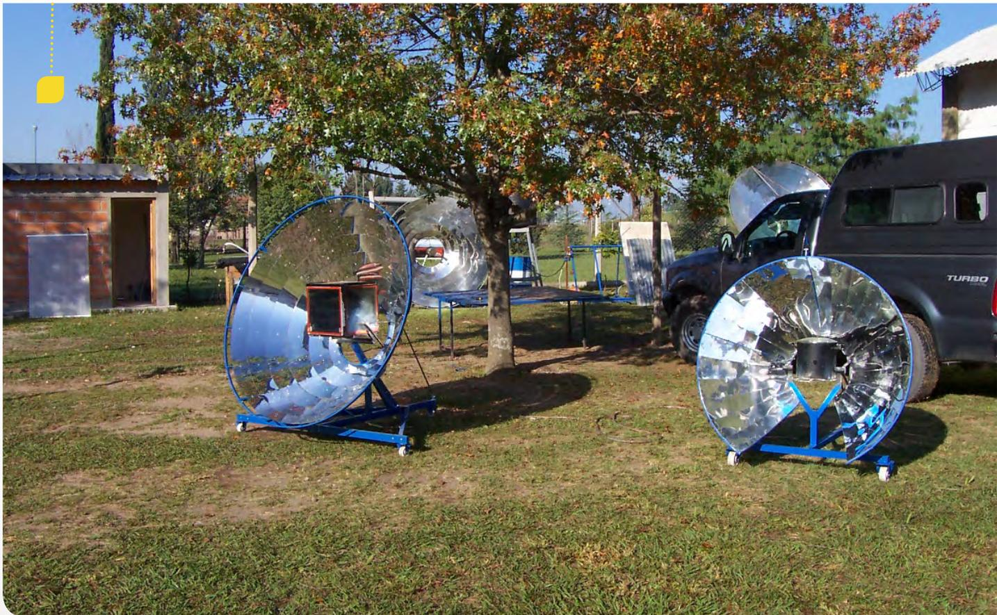
*Cocinas solares tipo concentrador, Campo Experimental del INENCO, Salta, 2009.*
