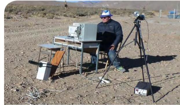
Procedimiento de medición en terreno de radiación solar directa global y espectral, El Rosal, Salta, 2014.
