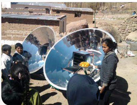
Capacitación e instalación de cocinas tipo concentrador en Río Grande, Angastaco, Salta, 2011.
