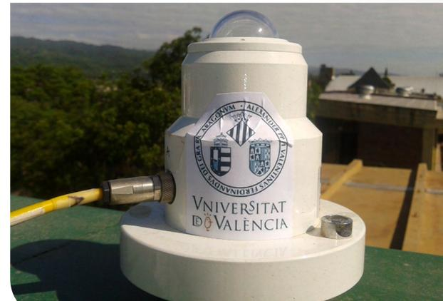
Radiómetro UV eritémica utilizado en mediciones de sitios de altura en la Prov. de Salta, 2012.
