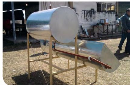
*Construcción de prototipo de calefón modelo Fisi semi-circular, INENCO, Salta, 2009.*
