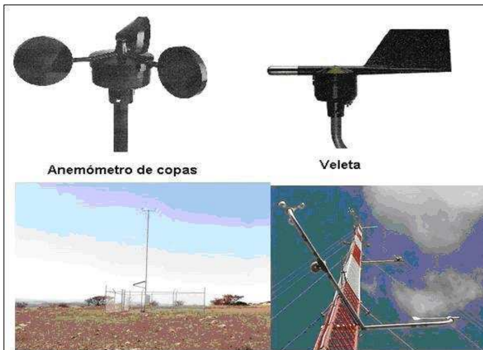
Figura 2.10: anemómetro de copas, veleta y torres anemométricas.
