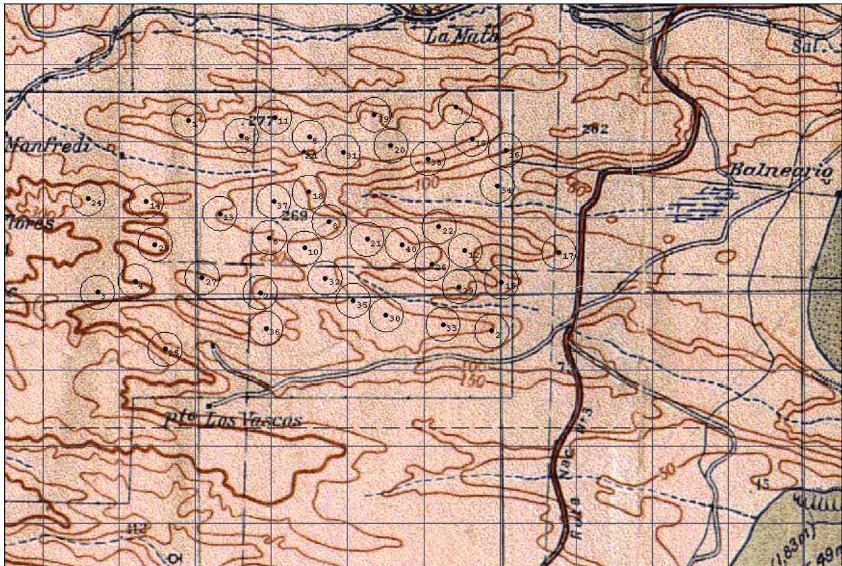
Figura 4.3: distribución de turbinas luego de la optimización hecha por el programa.
