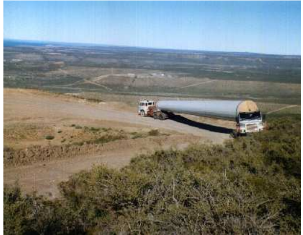
Construcción de la base y traslado de tramos de torre. Registro propio (PE Antonio Morán y PE Jorge Romanutti).
