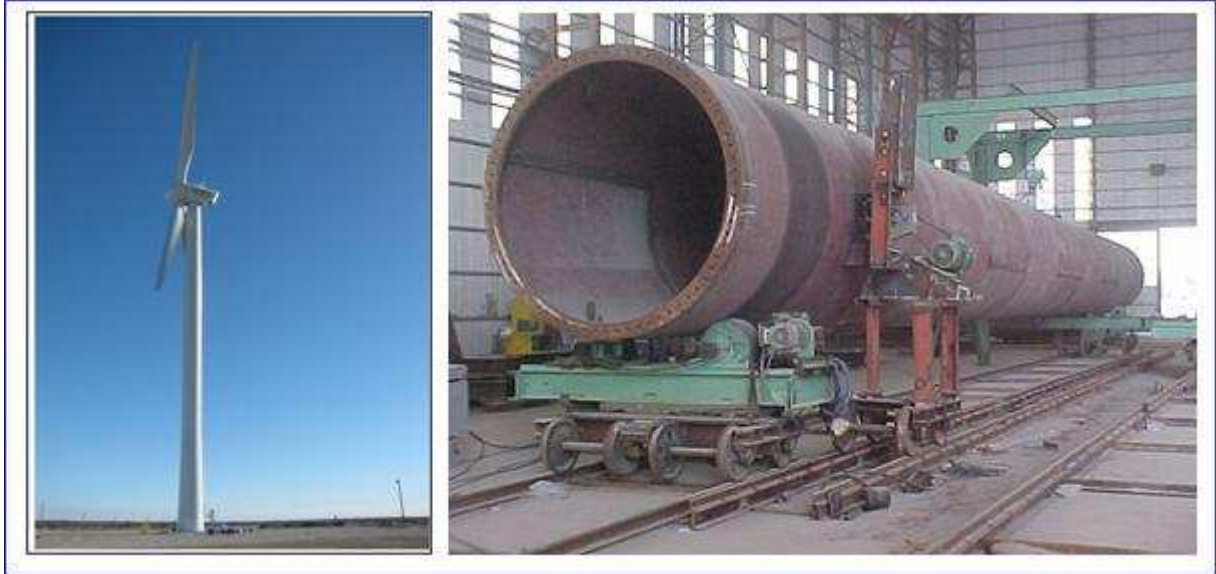
Figura 1.9: Molino en El Tordillo, Comodoro Rivadavia. [10], y Figura 1.10: fabricación de torres de aerogeneradores, Comodoro Rivadavia. [10].
