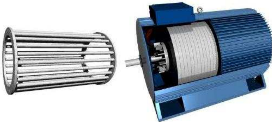
Figura 3.12a: barras y anillos del rotor de jaula, y vista del generador asíncrono
